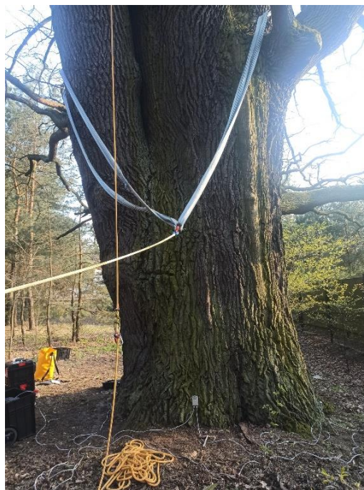
fot. 4.7.1.2 Próba obciążeniowa
