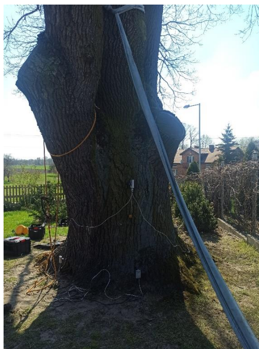
fot. 3.7.1.2 Próba obciążeniowa
