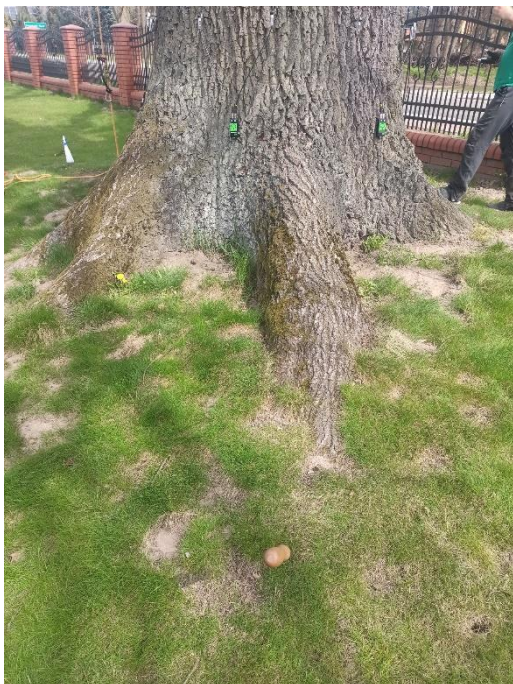
fot. 2.4.2.1 Wykryty rozkład w badaniu sondą arborystyczną
