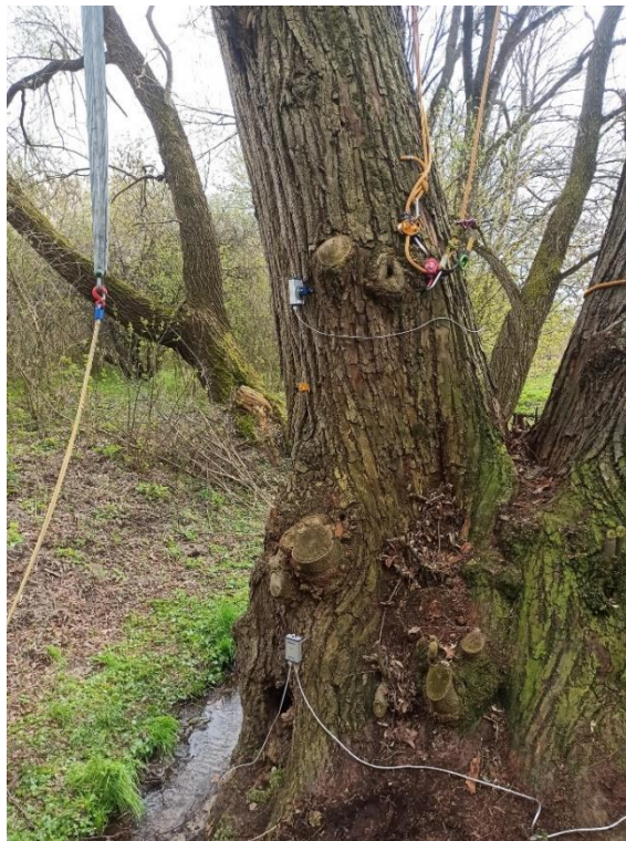
fot. 1.6.8.7 Próba obciążeniowa, pień E
